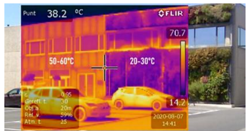
Figuur 5: Temperatureffect van gevelgroen tegen gebouw vs. in afwezigheid van gevelgroen (Greentexx by SIOEN)
